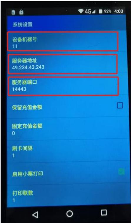
机器号、服务器IP、端口设置
